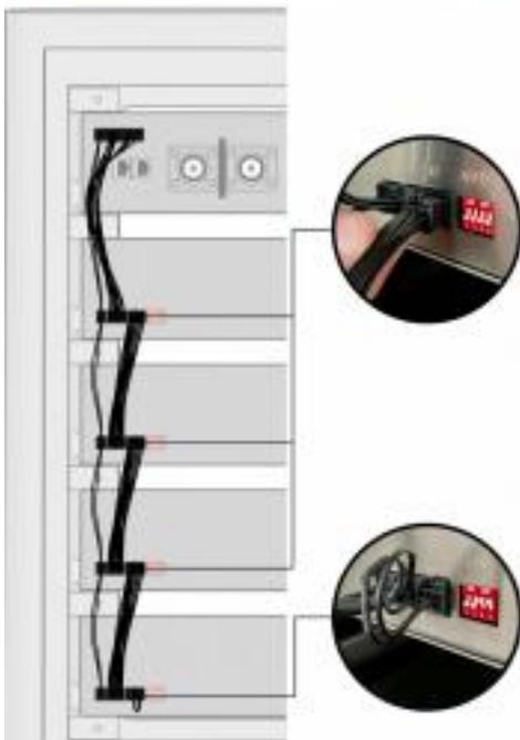
Verbinden Sie jedes weitere Batteriemodul mit einem symmetrischen Batteriemodul-Verbindungskabel (⊖), wie in der nebenstehenden Abbildung dargestellt (Daisy Chain):
