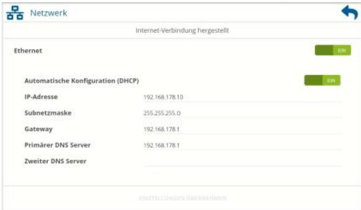
Bei aktivierter Schnittstelle wird Ihnen sowohl im Modus **Automatische Konfiguration (DHCP)**, als auch bei einer statischen Vergabe der Netzwerkparameter, die jeweils aktuellen Werte sowie der momentane Status zu Diagnosezwecken (hier **Internet-Verbindung hergestellt**) angezeigt.
