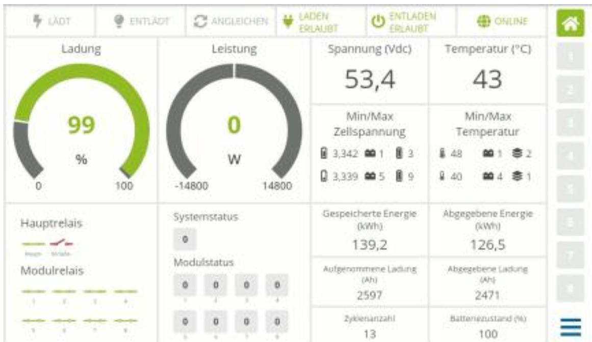
**HINWEIS** Solange Sie sich in der Hauptanzeige (Systemübersicht oder eine Modulanzeige) befinden können Sie durch Wischen nach oben oder unten oder das Antippen der Schaltflächen im Hauptnavigator zwischen den Anzeigen wechseln.
